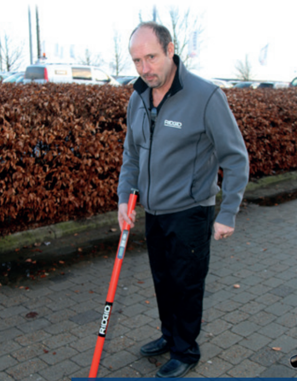
Jerndetektoren Ridgid MR-10 giver både audio- og videosignal, hvis der gemmer sig magnetfelter fra jernholdige materialer i dybet. Her er konsulent Bent Nielsen i aktion med stokken med røntgensyn.
