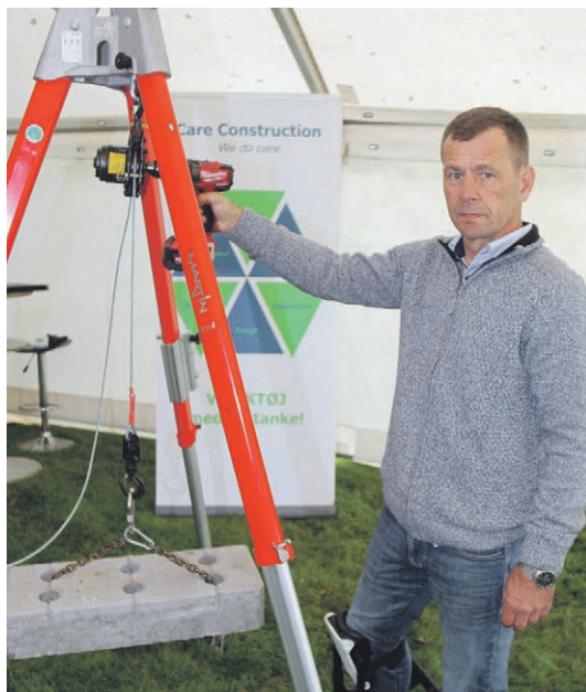
Henrik Hviid havde ikke en pumpe og en brønd med sig til messen på Mors. Så han brugte en betonklods til at demonstrere, hvordan en ganske almindelig skrue-/boremaskine med wirehejs kan løfte op til 600 kg.
