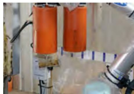
Robotten fra danske Bila Robotics i Nykøbing Mors dykker ned og samler to rør op ad gangen, dypper dem i varm olie og flytter dem videre til formen, hvor de bliver til muffer.
