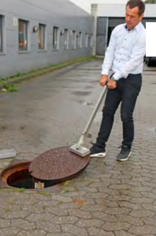
Den jyske opfinder læner sig lidt tilbage og rykker det tunge kloakdæksel af. Twisters magneter har en trækraft på omkring to tons.
